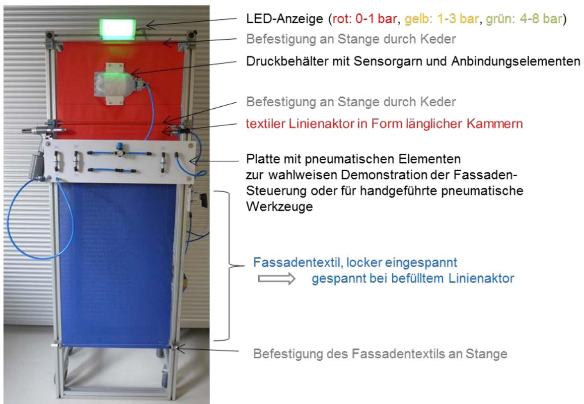
Abbildung 4: Druckbehälter-Demonstrator des ITV
